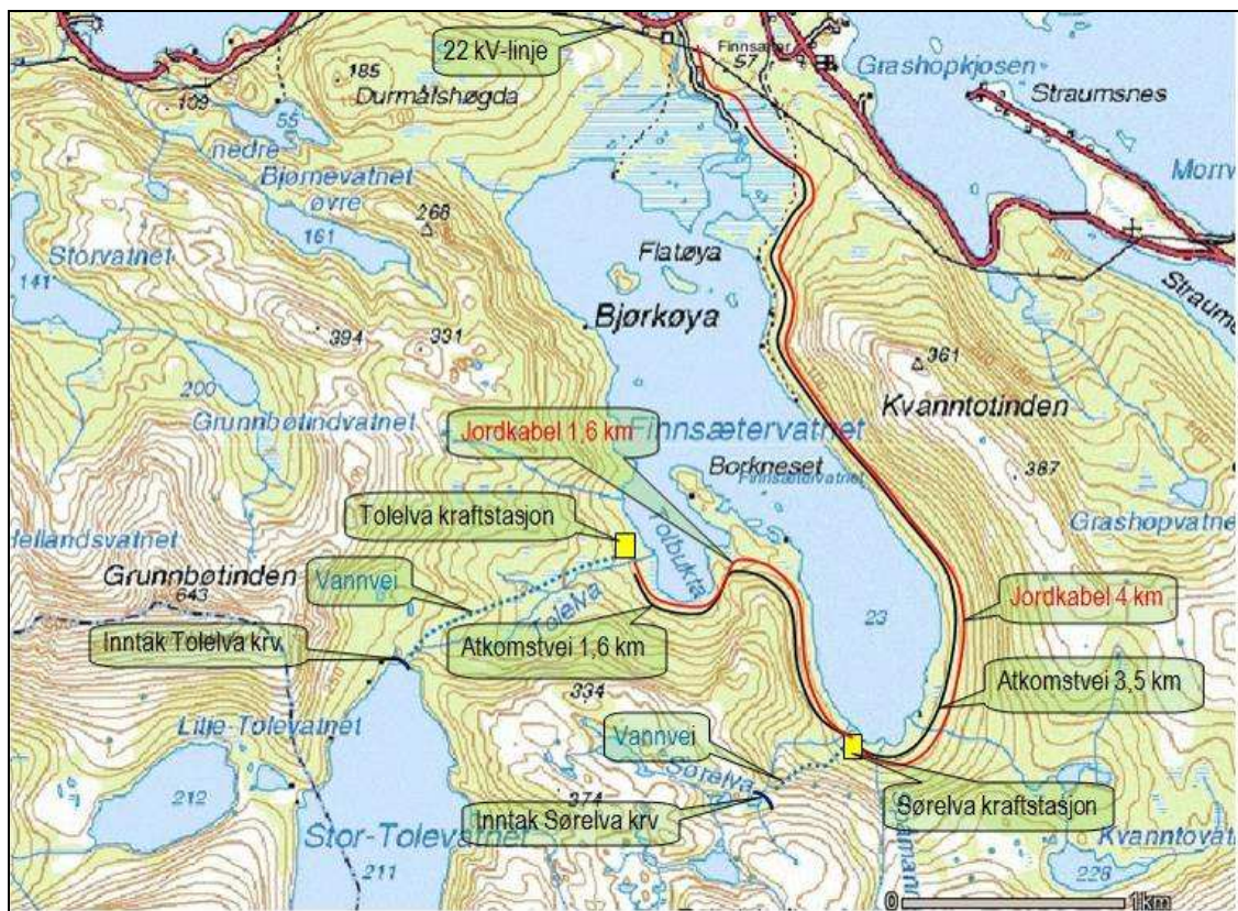
Figur 3. Utbyggers kart som viser planlagt permanent adkomst og nettilknytning for Sørrelva og Tolelva kraftverk.
